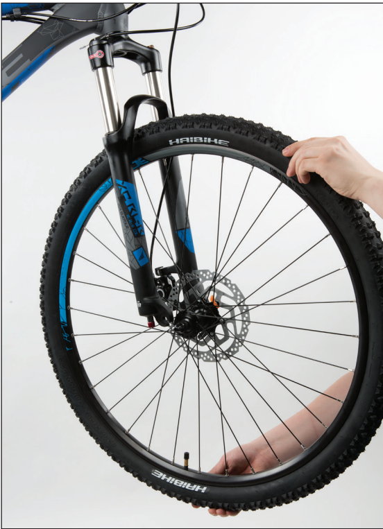
(Kuva 10) Varmista, että akseli istuu paikallaan ja että jarrulevy ei hankaa haarukan runkoa.
