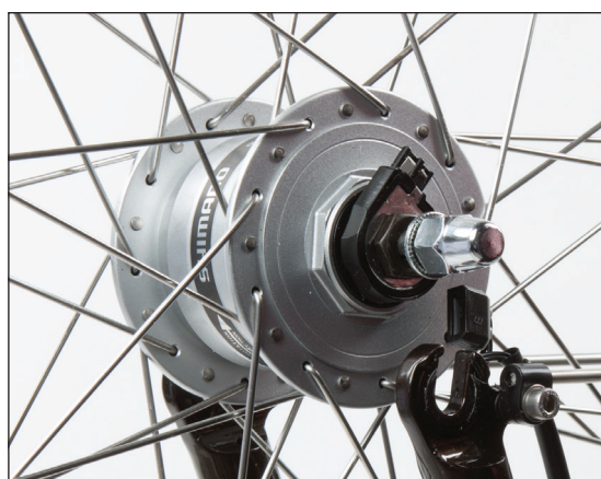
(Bild 6) Lossa axelns låsmuttrar.
