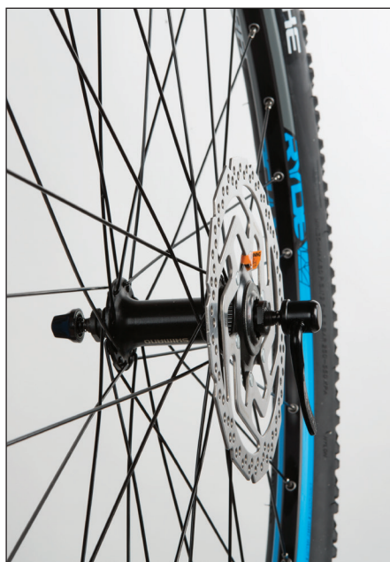
(Bild 4) Montera snabbkopplingen så att låsspaken sitter på vänster sida i färdriktningen.
