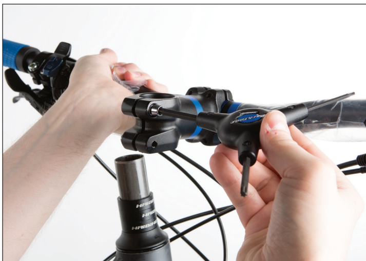
(Bild 18) Lossa på styrstammens skruvar
