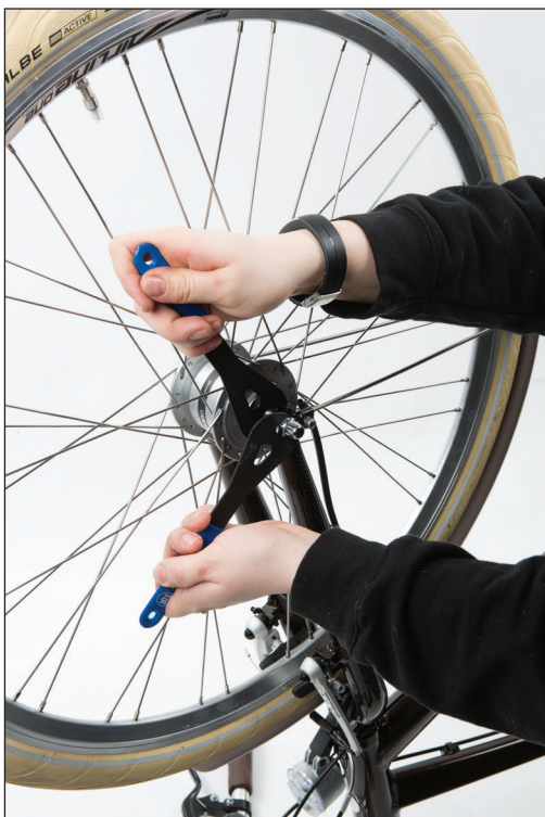
(Kuva 16) Kiristä mutterit tiukalle pyörän istuessa kunnolla haarukan hahloissa.
