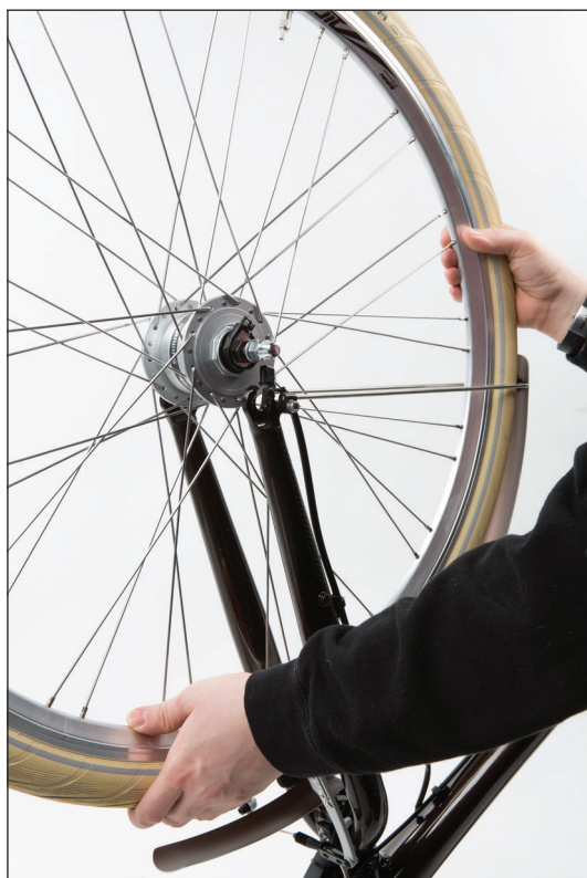
(Bild 11) Kom ihåg att brickorna på axeln ska ligga mellan gaffelklykorna och låsmuttrarna!
