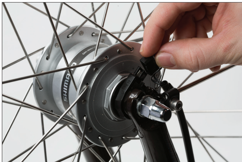
(Bild 17) Anslut navdynamons kontakt.
