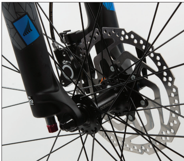
(Bild 10) Se till att axeln sitter på plats och att bromsskivan inte gnider mot gaffeln.
