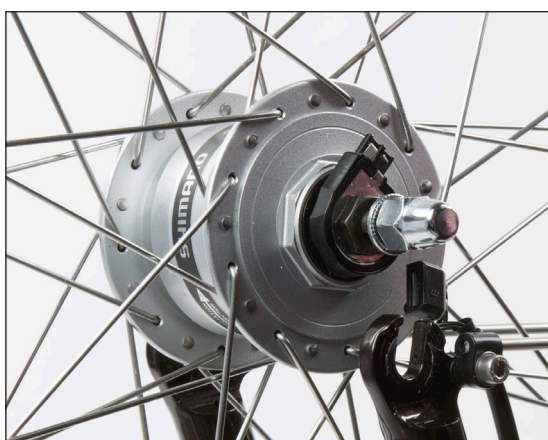
(Bild 6) Lossa axelns låsmuttrar.
