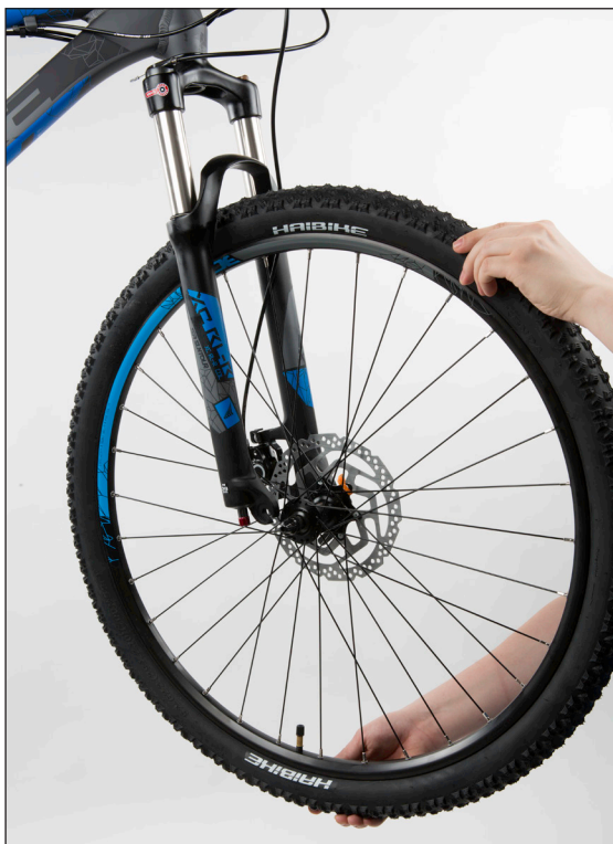
(Bild 9) Kom ihåg att brickorna på axeln ska ligga mellan gaffelklykorna och låsmuttrarna!
