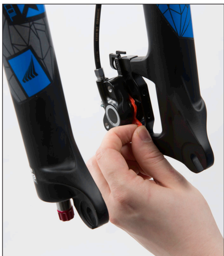
(Bild 8) Frambromsokets transportskydd.
