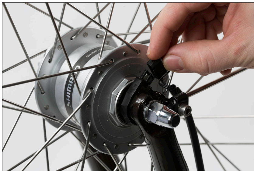
(Bild 17) Anslut navdynamons kontakt.
