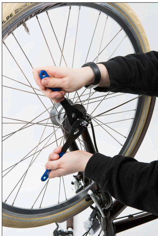
(Bild 16) Spänn muttrarna hårt medan hjulet sitter stadigt på plats i gaffelklykorna.
