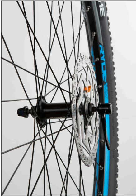
(Kuva 4) Asenna pikalinkku niin, että lukitusvipu jää vasemmalle puolelle ajosuuntaan katsoessa.
