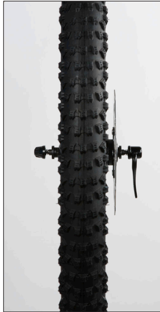
(Kuva 5) Pikalinkku asennettuna
