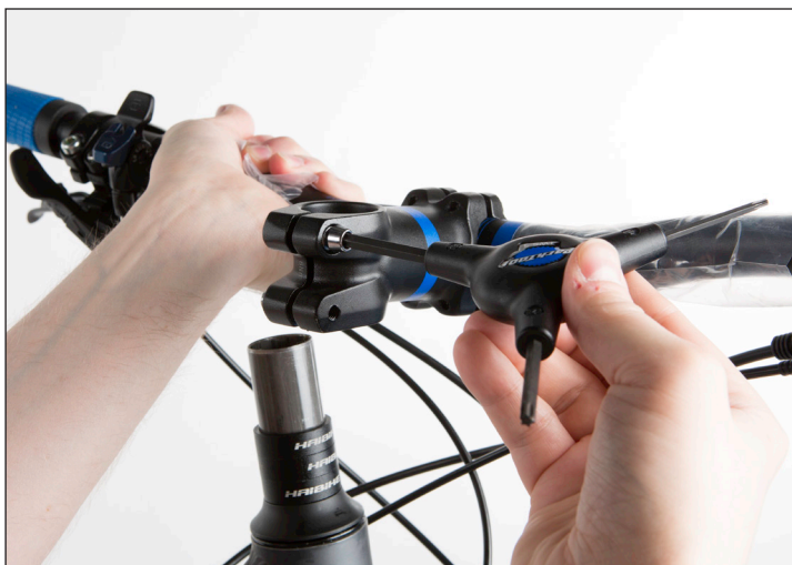
(Kuva 18) Löysää ohjainkannattimen ruuveja
