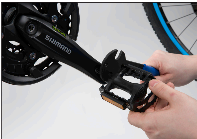
(Kuva 25) Oikeanpuoleisen polkimien asennus.
