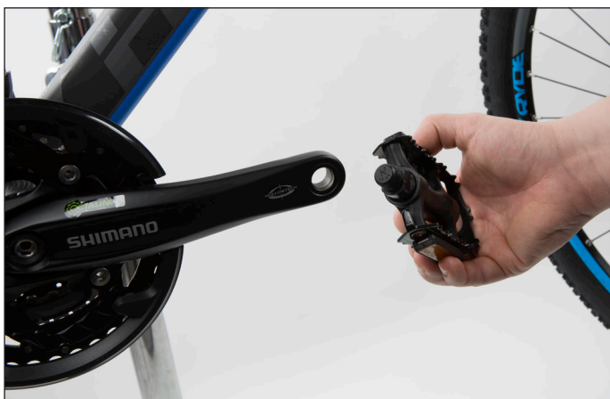
(Kuva 25) Oikeanpuoleisen polkimien asennus.
