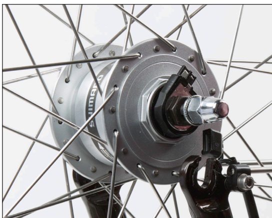
(Kuva 6) Löysää kierreakselin lukkomutterit
