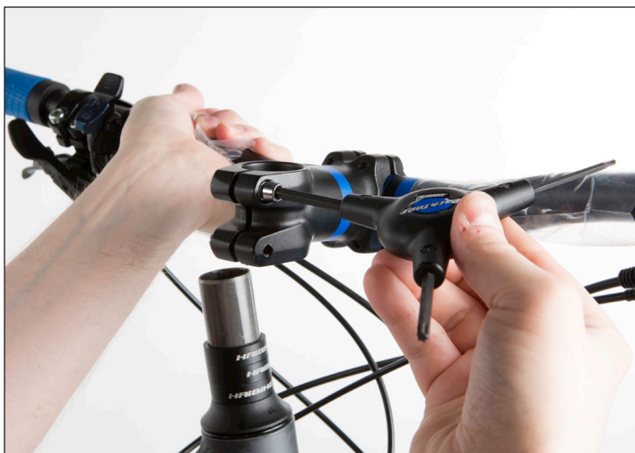
(Bild 18) Lossa på styrstammens skruvar
