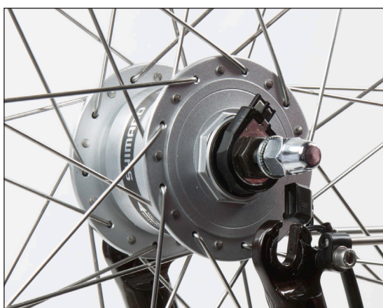
(Bild 6) Lossa axelns låsmuttrar.
