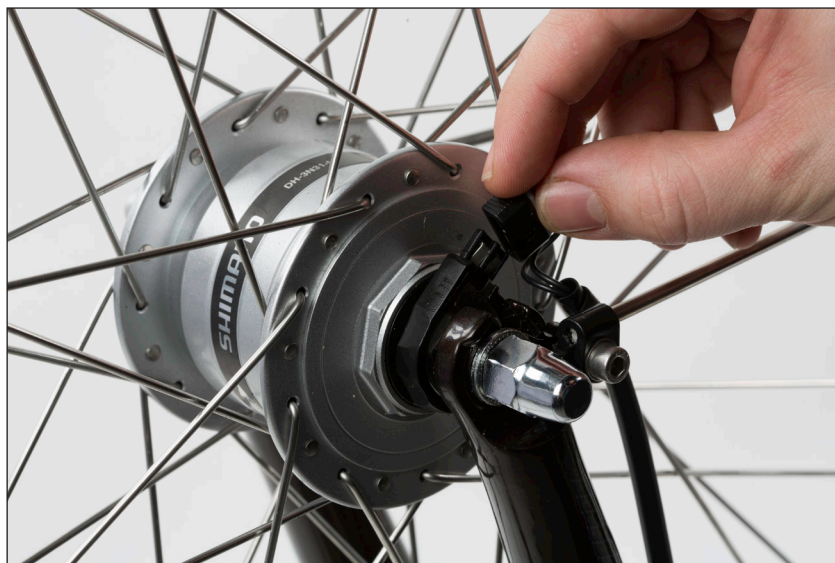
(Bild 17) Anslut navdynamons kontakt.
