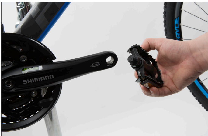
(Bild 25) Montering av höger pedal
