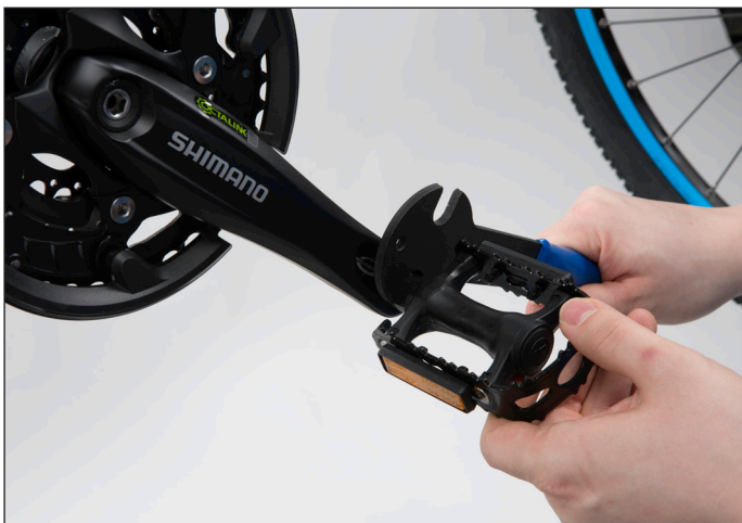
(Bild 25) Montering av höger pedal
