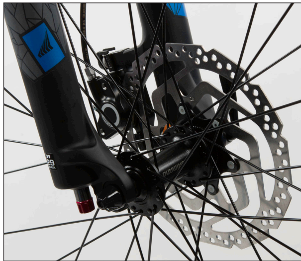
(Kuva 10) Varmista, että akseli istuu paikallaan ja että jarrulevy ei hankaa haarukan runkoa.
