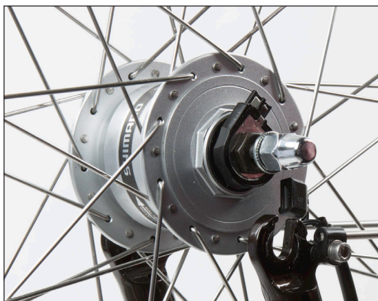
(Kuva 6) Löysää kierreakselin lukkomutterit
