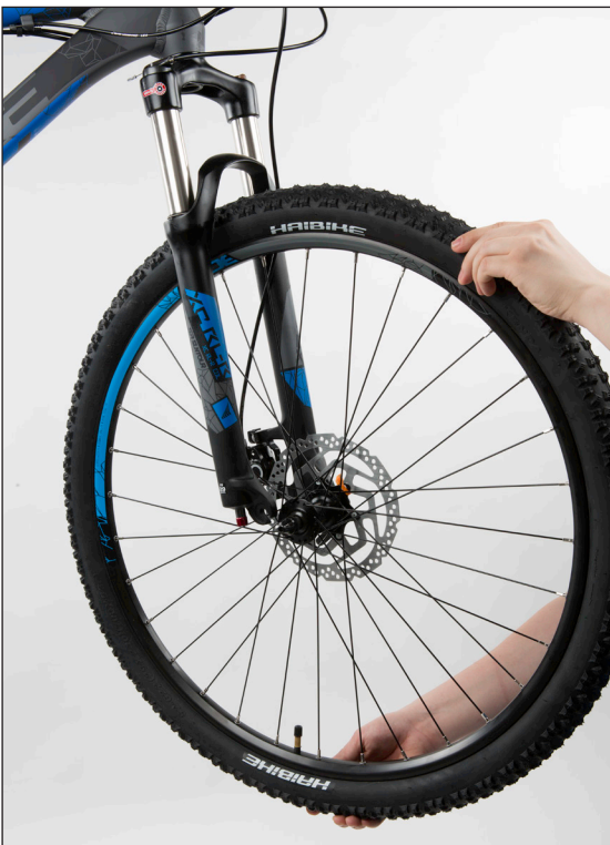
(Kuva 9) Muista että akselissa mahdollisesti olevat prikät jäävät hahlojen ja lukkomutterien väliin!
