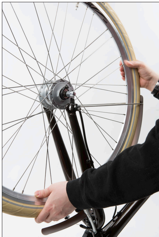
(Kuva 11) Muista, että akselissa olevat prikät jäävät hahlojen ja lukkomutterien väliin!
