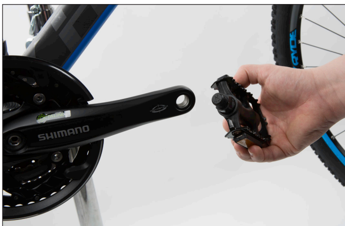
(Kuva 25) Oikeanpuoleisen polkimien asennus.
