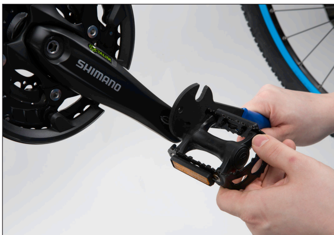
(Kuva 25) Oikeanpuoleisen polkimien asennus.
