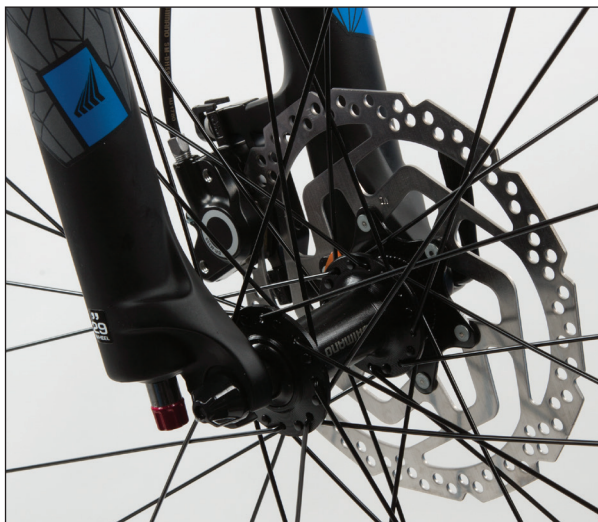
(Bild 10) Centrera bromsskivan i bromsoket.
