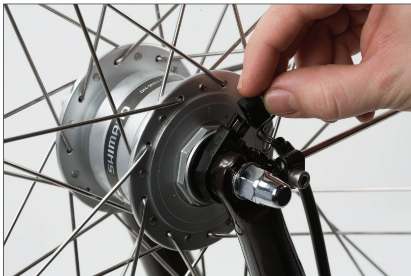
(Bild 17) Anslut navdynamons kontakt.
